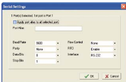
Rys. 5. Ustawienie parametrów transmisji szeregowej
