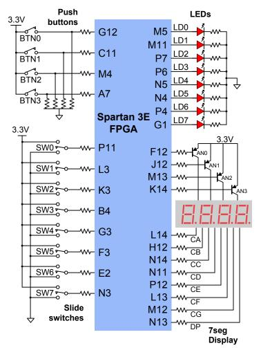
Figure 6. Basys2 I/O circuits
