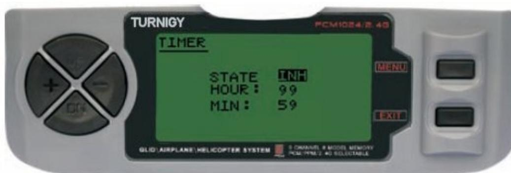
Entre no menu FUNC SETTINGS, pressione a tecla MENU. Utilizando as teclas UP/DOWN selecione a função TIMER e pressione a tecla MENU para acessar. Com as teclas +/- selecione INH ou ACT para apagar ou ativar esta função. Pressione a tecla MENU para gravar a nova configuração e voltar ao menu anterior ou pressione EXIT para sair sem salvar as configurações.
