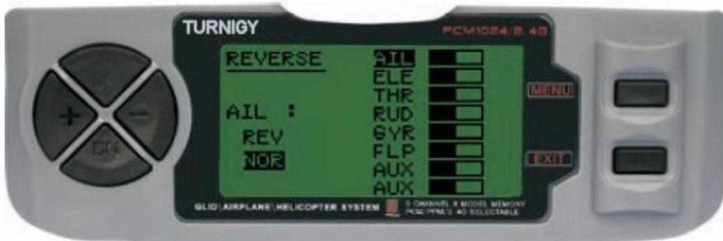
Entre no menu FUNC SETTINGS, pressione a tecla MENU. Utilizando as teclas UP/DOWN selecione a função REVERSE. Com as teclas +/- ative esta função no servo de sua escolha. Pressione a tecla MENU para gravar a nova configuração e voltar ao menu anterior ou pressione EXIT para sair sem salvar as configurações.
