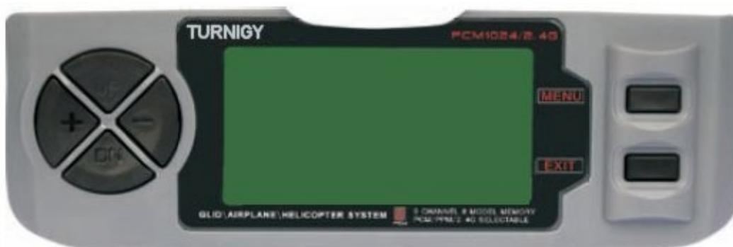
Entre no menu FUNC SETTINGS, pressione a tecla MENU. Utilizando as teclas UP/DOWN selecione a função E.POINT e pressione MENU para acessar. Com as teclas UP/ DOWN selecione o canal que se deseja ajustar. Com as teclas +/- ajuste o limite de percurso do servo correspondente ao canal selecionado. Pressione a tecla MENU para gravar a nova configuração e voltar ao menu anterior ou pressione EXIT para sair sem salvar as configurações.
