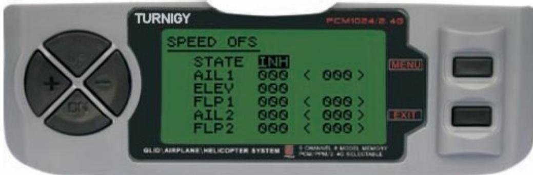
Entre no menu FUNC SETTINGS, pressione a tecla MENU. Utilizando as teclas UP/DOWN selecione a função SPEEDOFS e pressione a tecla MENU para acessar. Com as teclas +/- selecione INH ou ACT para apagar o encender esta función. Una vez hecho esto, nuevamente con las teclas + / - asigne el valor deseado de ajuste para los Alerones, Elevador y Flaps. Pressione a tecla MENU para gravar a nova configuração e voltar ao menu anterior ou pressione EXIT para sair sem salvar as configurações.
