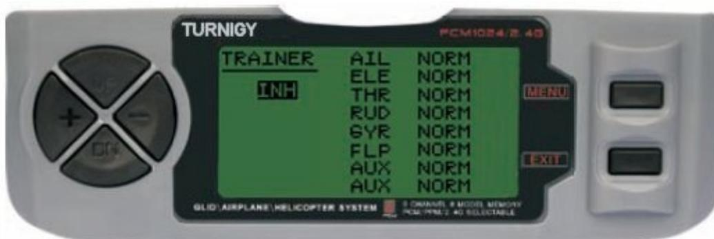
Entre no menu FUNC SETTINGS, pressione a tecla MENU. Utilizando as teclas UP/DOWN selecione a função TRAINER e pressione a tecla MENU para acionar. Com as teclas +/- selecione *NORM* ou *FUNC* para cada canal. Pressione a tecla MENU para gravar a nova configuração e voltar ao menu anterior ou pressione EXIT para sair sem salvar as configurações.
