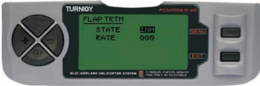
Entre no menu FUNC SETTINGS, pressione a tecla MENU. Utilizando as teclas UP/DOWN selecione a função FLAP TRIM e pressione a tecla MENU para acessar. Com as teclas +/- selecione INH ou ACT para desativar ou ativar esta função. Com as teclas +/- atribuir a configuração desejada para esse controle. Pressione a tecla MENU para gravar a nova configuração e voltar ao menu anterior ou pressione EXIT para sair sem salvar as configurações.
