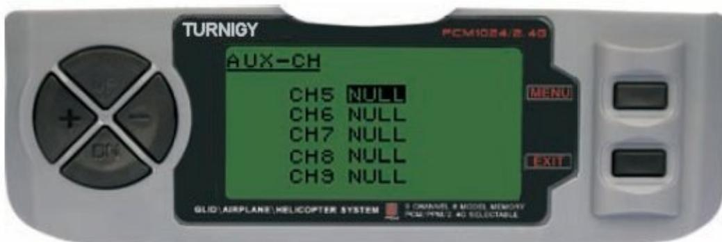
Entre no menu FUNC SETTINGS, pressione a tecla MENU. Utilizando as teclas UP/DOWN selecione a função AUX-CH e pressione MENU para acessar. Com as teclas UP/ DOWN selecione o canal que se deseja ajustar. Com as teclas +/- ajuste o canal desejado. Pressione a tecla MENU para gravar a nova configuração e voltar ao menu anterior ou pressione EXIT para sair sem salvar as configurações.
