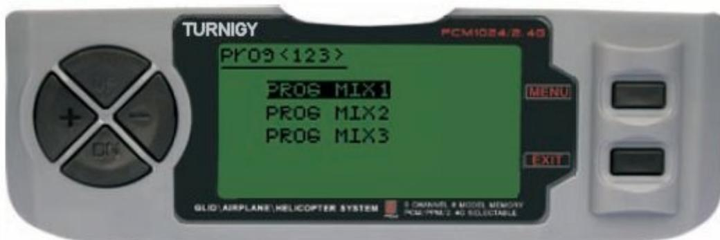
Entre no menu FUNC SETTINGS, pressione a tecla MENU. Utilizando as teclas UP/DOWN selecione a função PROG<123> e pressione MENU para acessar. Com as teclas UP/DOWN selecione a mistura que ira utilizar. Pressione a tecla MENU para entrar em um Sub-menu da Mistura selecionada ou pressione a tecla EXIT para cancelar ou sair.
