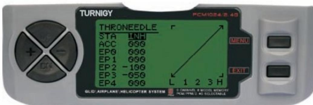
Entre no menu FUNC SETTINGS, pressione a tecla MENU. Utilizando as teclas UP/DOWN selecione a função THROTTLE-NEEDLE e pressione a tecla MENU para acessar. Com as teclas +/- selecione INH ou ACT para desativar ou ativar esta função. Com as teclas +/- insira o valor de ajuste dos parametros da mistura desejada.. Pressione a tecla MENU para gravar a nova configuração e voltar ao menu anterior ou pressione EXIT para sair sem salvar as configurações.
