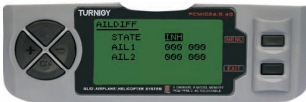
Os ailerons NÃO podem trabalhar como Flaps no modo AIL-DIFF a menos que estejam configurados como AIRBRAKE. Tenha em mente que se você tiver ativado o FLAP-TRIM enquanto utiliza AIL-DIFF, este não terá efeito algum sobre os ailerons. Somente a função AIRBRAKE pode controlar os ailerons no modo Flaps, estando em modo AIL-DIFF.
