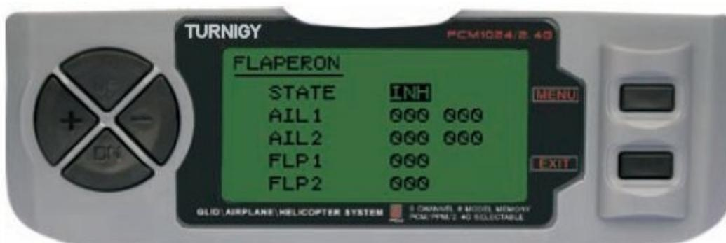
Entre no menu FUNC SETTINGS, pressione a tecla MENU. Utilizando as teclas UP/DOWN selecione a função FLAPERON e pressione a tecla MENU para acessar. Com as teclas +/- selecione STATE: INH = Desativado / ACT = Ativado. Tambiem com +/- modifique os valores AIL1 ( Aileron 1), AIL2 ( Aileron 2), FLP1 ( Flap 1 ), FLP2 ( Flap 2 ) dentro do valor escolhido. Pressione a tecla MENU para gravar a nova configuração e voltar ao menu anterior ou pressione EXIT para sair sem salvar as configurações.
