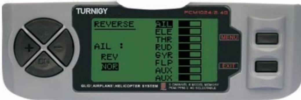
Entre no menu FUNC SETTINGS, pressione a tecla MENU. Utilizando as teclas UP/DOWN selecione a função REVERSE. Com as teclas + / - aplique esta função ao servo selecionado. Pressione a tecla MENU para gravar a nova configuração e voltar ao menu anterior.
