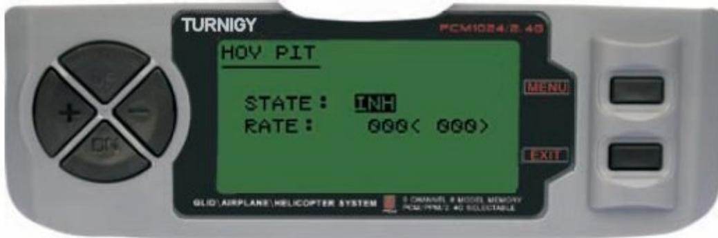
Entre no menu FUNC SETTINGS, pressione a tecla MENU. Utilizando as teclas UP/DOWN selecione a função HOV PIT y pulse MENU para acessar. Com as teclas +/- selecione INH ou ACT. Modifique o valor de ajuste. Pressione a tecla MENU para gravar a nova configuração e voltar ao menu anterior ou pressione EXIT para sair sem salvar as configurações.
