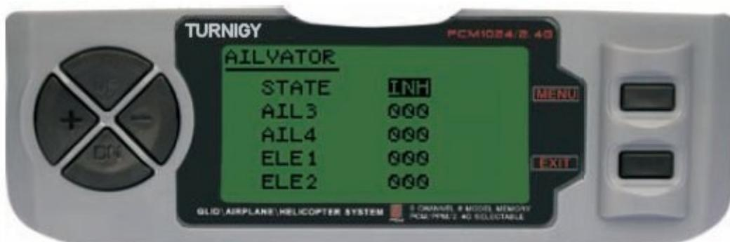
Entre no menu FUNC SETTINGS, pressione a tecla MENU. Utilizando as teclas UP/DOWN selecione a função AILVATOR e pressione a tecla MENU. Com as teclas +/- selecione INH ou ACT para desativar ou ativar esta função. Com as teclas +/- insira o valor de ajuste para cada Aileron e Profundor. Pressione a tecla MENU para gravar a nova configuração e voltar ao menu anterior ou pressione EXIT para sair sem salvar as configurações.
