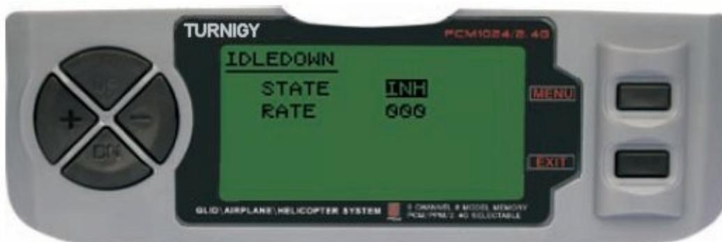
Entre no menu FUNC SETTINGS, pressione a tecla MENU. Utilizando as teclas UP/DOWN selecione a função IDLEDOWN e pressione a tecla MENU para acessar. Com as teclas +/- selecione STATE: INH = Desativado / ACT = Ativado. Também com +/- ajuste/atribue um valor de aceleração desejado. Pressione a tecla MENU para gravar a nova configuração e voltar ao menu anterior ou pressione EXIT para sair sem salvar as configurações.
