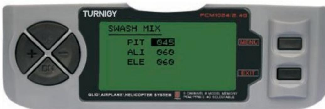
Entre no menu FUNC SETTINGS, pressione a tecla MENU. Utilizando as teclas UP/DOWN selecione a função SWASH MIX e pressione a tecla MENU para acessar. Com as teclas UP/ DOWN selecione o canal que se deseja ajustar. Com as teclas +/- ajuste a mistura. Pressione a tecla MENU para gravar a nova configuração e voltar ao menu anterior ou pressione EXIT para sair sem salvar as configurações.
