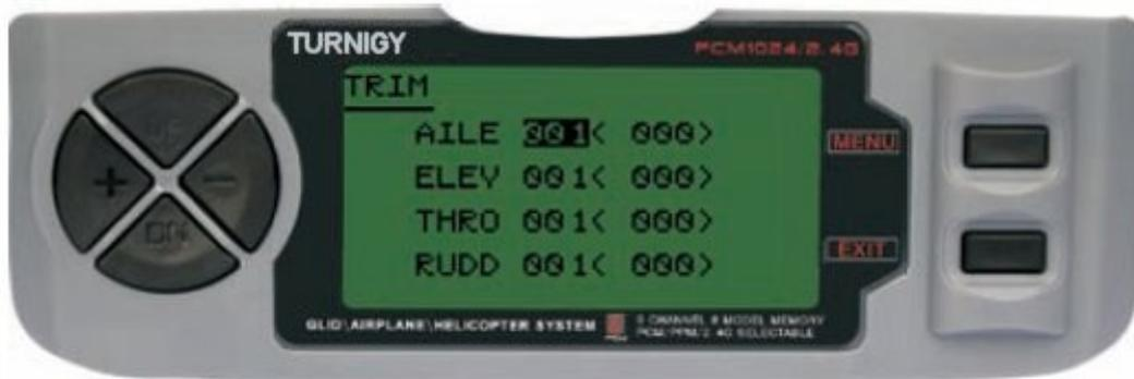
Entre no menu FUNC SETTINGS, pressione a tecla MENU. Utilizando as teclas UP/DOWN selecione a função TRIM e pressione MENU para acessar. Com as teclas UP/ DOWN selecione o canal que se deseja ajustar. Com as teclas +/- ajuste o mesmo. Pressione a tecla MENU para gravar a nova configuração e voltar ao menu anterior ou pressione EXIT para sair sem salvar as configurações.
