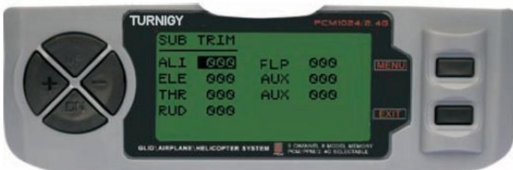
Entre no menu FUNC SETTINGS, pressione a tecla MENU. Utilizando as teclas UP/DOWN selecione a função SUB TRIM e pressione a tecla MENU para acessar. Com as teclas UP/DOWN selecione o canal a ajustar. Com as teclas +/- ajuste a posição do servo correspondente ao canal escolhido. Pressione a tecla MENU para gravar a nova configuração e voltar ao menu anterior ou pressione EXIT para sair sem salvar as configurações.
