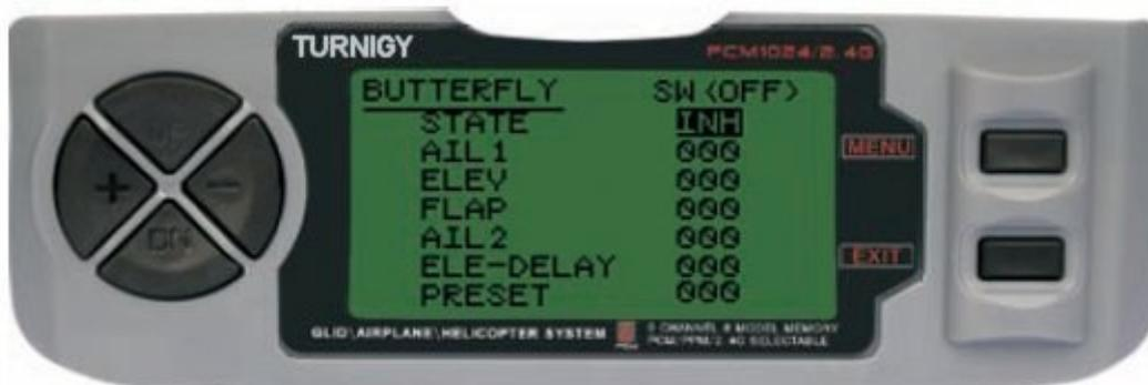
Entre no menu FUNC SETTINGS, pressione a tecla MENU. Utilizando as teclas UP/DOWN selecione a função BUTTERFLY e pressione a tecla MENU para acessar. Com as teclas +/- selecione INH ou ACT para ativar ou desativar esta função. Com as teclas +/- insira o valor de ajuste para os Ailerons, Profundor, Flaps, Leme e Delay (atraso) para o Profundor (se necessário). Pressione a tecla MENU para gravar a nova configuração e voltar ao menu anterior ou pressione EXIT para sair sem salvar as configurações.
