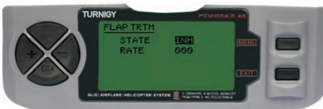
Entre no menu FUNC SETTINGS, pressione a tecla MENU. Utilizando as teclas UP/DOWN selecione a função FLAP TRIM e pressione a tecla MENU para acessar. Com as teclas +/- selecione
