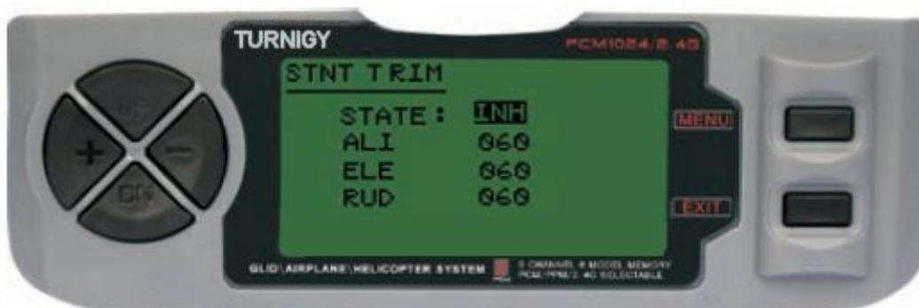
Entre no menu FUNC SETTINGS, pressione a tecla MENU. Utilizando as teclas UP/DOWN selecione a função STUNT TRIM e pressione a tecla MENU para acessar. Com as teclas +/- selecione STATE: INH = Desativado / ACT = Ativado. Também com +/- modifique os valores ALI (Aileron), ELE (Elevação, Profundor), RUD (Rotor de Couda, Leme) dentro dos limites designados. Pressione a tecla MENU para gravar a nova configuração e voltar ao menu anterior ou pressione EXIT para sair sem salvar as configurações.
