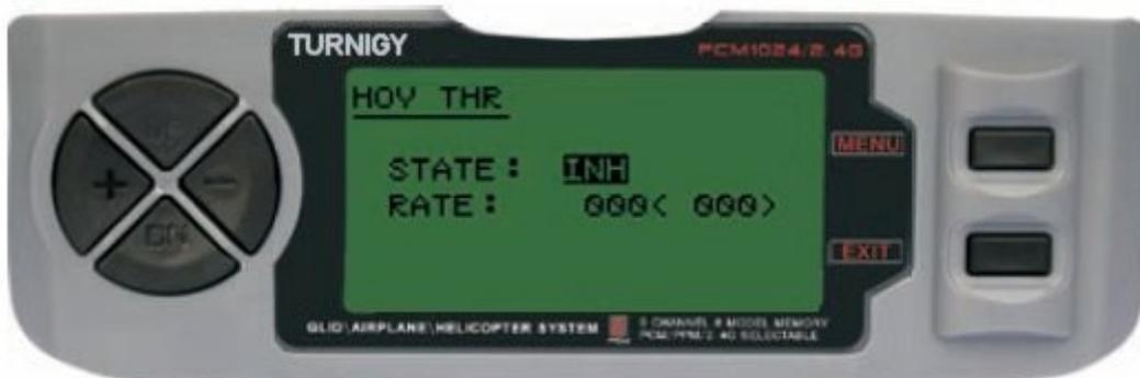
Entre no menu FUNC SETTINGS, pressione a tecla MENU. Utilizando as teclas UP/DOWN selecione a função HOV THR e pressione a tecla MENU para acessar. Com as teclas +/- selecione INH ou ACT. Pressione a tecla MENU para gravar a nova configuração e voltar ao menu anterior ou pressione EXIT para sair sem salvar as configurações.
