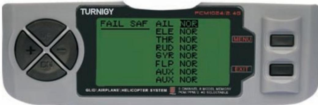
Entre no menu FUNC SETTINGS, pressione a tecla MENU. Utilizando as teclas UP/DOWN selecione a função FAIL SAF pressione a tecla MENU para acessar. Com as teclas +/- selecione NOR o F/S. Pressione a tecla MENU para gravar a nova configuração e voltar ao menu anterior ou pressione EXIT para sair sem salvar as configurações.
