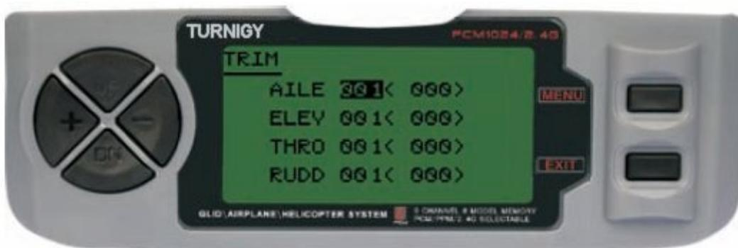
Entre no menu FUNC SETTINGS, pressione a tecla MENU. Utilizando as teclas UP/DOWN selecione a função TRIM e pressione MENU para acessar. Com as teclas UP/ DOWN selecione o
