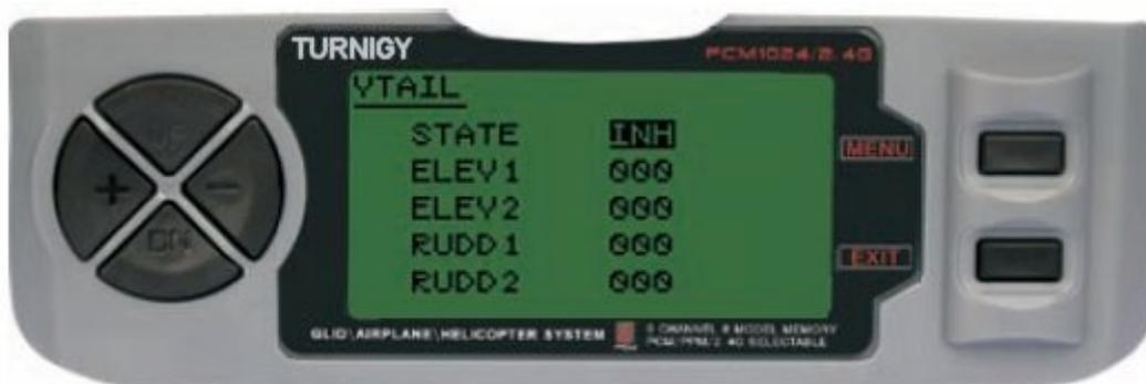
Entre no menu FUNC SETTINGS, pressione a tecla MENU. Utilizando as teclas UP/DOWN selecione a função VTAIL e pressione a tecla MENU. Com as teclas +/- selecione INH ou ACT para desativar ou ativar esta função. Com as teclas +/- insira o valor de ajuste para os Profundores e Leme (s). Pressione a tecla MENU para gravar a nova configuração e voltar ao menu anterior ou pressione EXIT para sair sem salvar as configurações.
