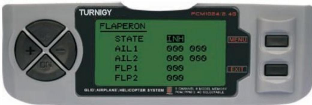
Entre no menu FUNC SETTINGS, pressione a tecla MENU. Utilizando as teclas UP/DOWN selecione a função FLAPERON e pressione a tecla MENU para acessar. Com as teclas +/- selecione STATE: INH = Desativado / ACT = Ativado. Também com +/- modifique os valores AIL1 ( Aileron 1), AIL2 ( Aileron 2), FLP1 ( Flap 1 ), FLP2 ( Flap 2 ) dentro do valor escolhido. Pressione a tecla MENU para gravar a nova configuração e voltar ao menu anterior ou pressione EXIT para sair sem salvar as configurações.
