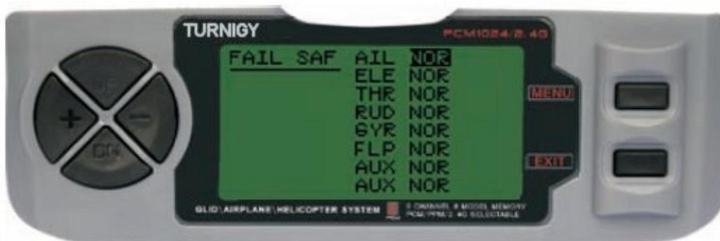
Entre no menu FUNC SETTINGS, pressione a tecla MENU. Utilizando as teclas UP/DOWN selecione a função FAIL SAF e pressione a tecla MENU para acionar. Com as teclas +/- selecione NOR ou F/S. Pressione a tecla MENU para gravar a nova configuração e voltar ao menu anterior ou pressione EXIT para sair sem salvar as configurações.
