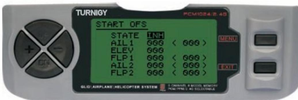
Entre no menu FUNC SETTINGS, pressione a tecla MENU. Utilizando as teclas UP/DOWN selecione a função STARTOFS e pressione a tecla MENU para acessar. Com as teclas +/- insira o valor de ajuste para os Ailerons, Profundor e Flaps. Pressione a tecla MENU para gravar a nova configuração e voltar ao menu anterior ou pressione EXIT para sair sem salvar as configurações.
