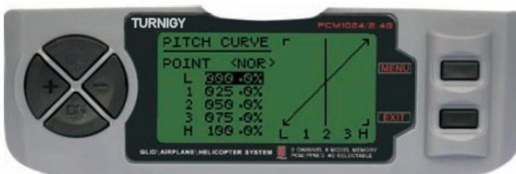
Entre no menu FUNC SETTINGS, pressione a tecla MENU. Utilizando as teclas UP/DOWN selecione a função PITCH CURVE e pressione a tecla MENU para acessar. Com as teclas UP/DOWN selecione a Curva que deseja configurar/editar. Com as teclas +/- ajuste o valor conveniente de passo nesse ponto. Pressione a tecla MENU para gravar a nova configuração e voltar ao menu anterior ou pressione EXIT para sair sem salvar as modificações.
