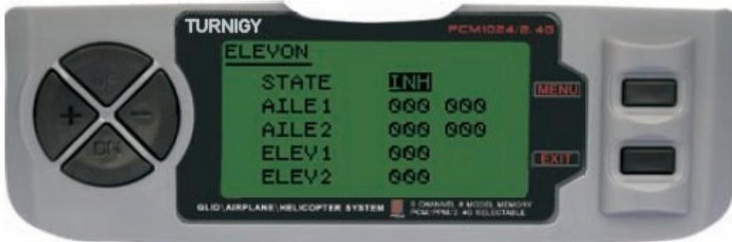
Entre no menu FUNC SETTINGS, pressione a tecla MENU. Utilizando as teclas UP/DOWN selecione a função ELEVON y pulse MENU para acceder. Luego, con las teclas + / - seleccione INH o ACT para apagar o encender esta función. Una vez hecho esto, nuevamente con las teclas + / - asigne el valor deseado de ajuste para los Alerones y Elevador(es). Pressione a tecla MENU para gravar a nova configuração e voltar ao menu anterior ou pressione EXIT para sair sem salvar as configurações.
