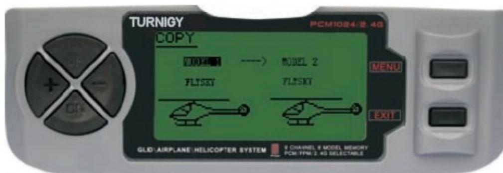
Entre no menu SYSTEM SETTINGS, selecione a opção COPY, pressione a tecla MENU. Usando as teclas UP / DOWN ) entre na coluna da esquerda, chamada SOURCE (origem a partir da qual pretende copiar as informações) e a coluna da direita, DEST (onde você copiou as informações.)
