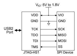
**JTAG-HS1 SPI Device Connections**
