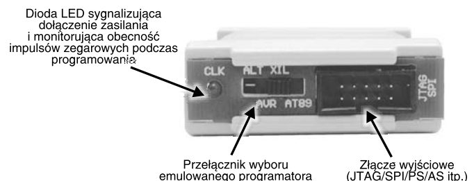
Fot. 2. Rozmieszczenie elementów na tylnej części programatora ZL11PRG-M
